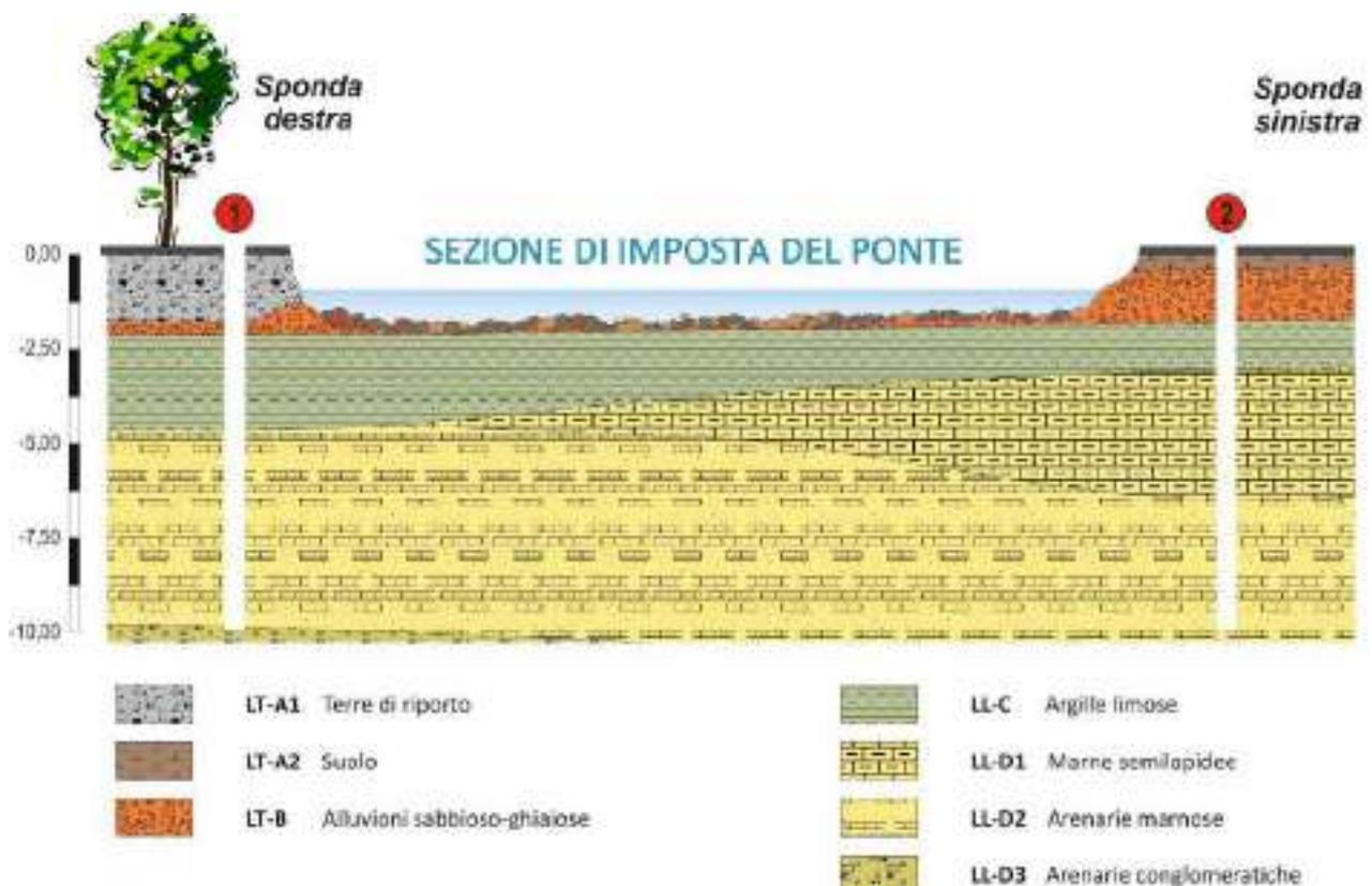
FIGURA 3.2 – Sezione geologica schematica in corrispondenza della sezione di imposta del ponte.
